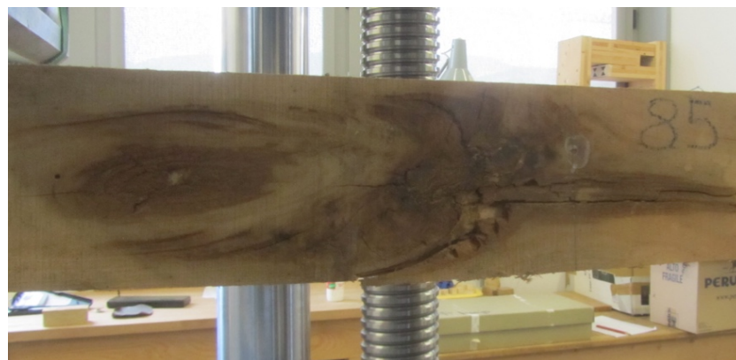
Figura 1 – Carie molto estesa in un campione di castagno.
