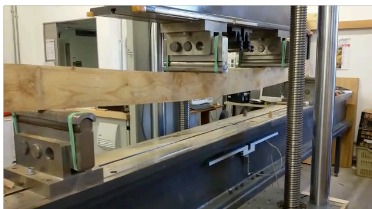
Figura 4 – Prova a flessione a 4 punti.
