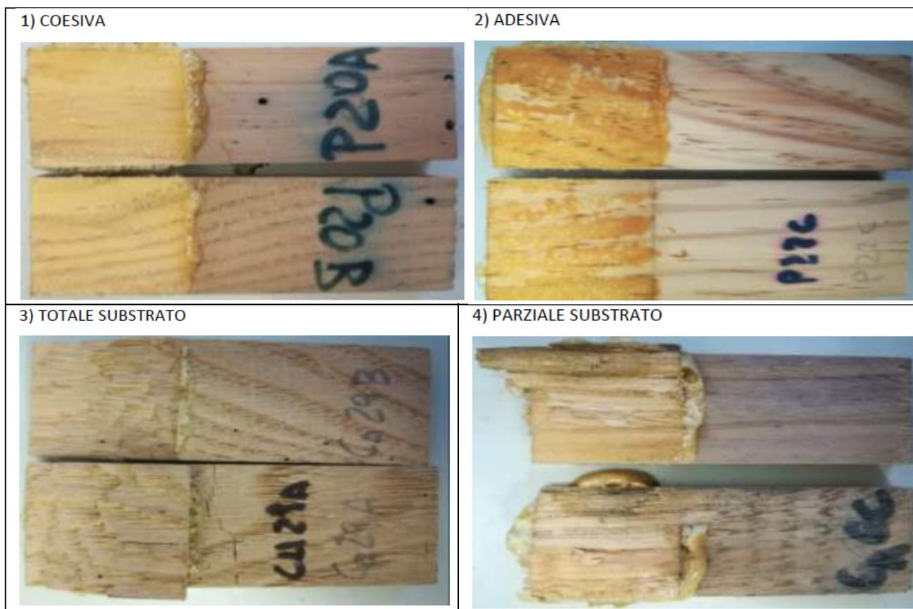
Figura 4. Esempi di tipologia di rottura
